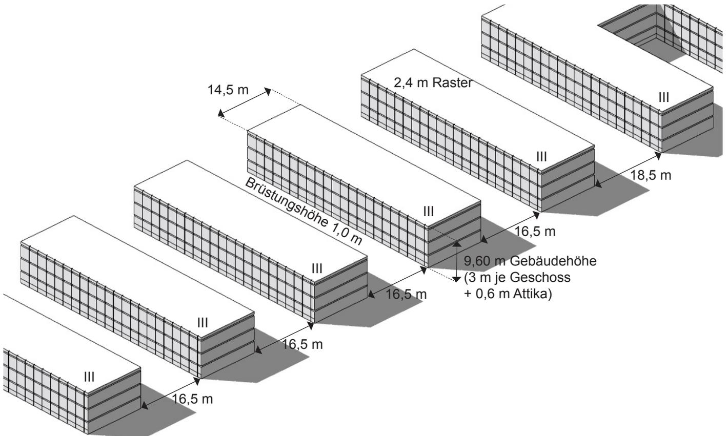
Abb.: Ausgangssituation in der Planzeichnung und Parameter zur Ermittlung einer ausreichenden Besonnung
