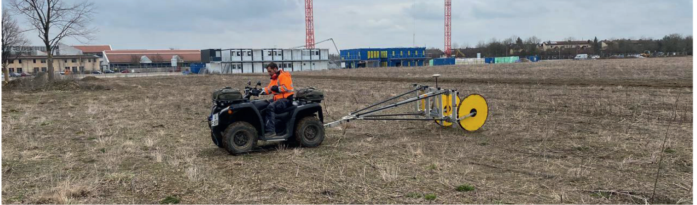
Ein Mitarbeiter der Firma Geomer aus Augsburg beim Sondieren der Flächen auf mögliche metallische Gegenstände im Boden.
