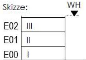
Die zulässige maximale Wandhöhe darf durch Aufzugsüberfahrten sowie technische Anlagen zur Be- und Entlüftung um maximal 1,5 m überschritten werden.
