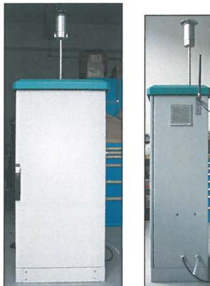
Abbildung 1: Probenahmegerät PM10-Konzentration
