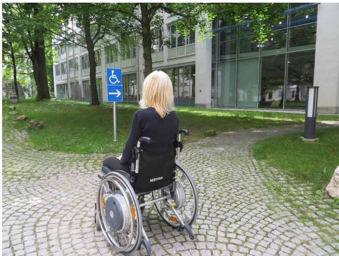
Abbildung 12 Zugang für Rollstuhlfahrer zum Landratsamt München mit problematischer Pflasterung
